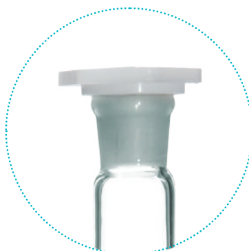
исп. 2а с одной меткой и пластмассовой пробкой
