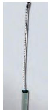
По принципу действия работа мерзлотомера основана на помещении защитной трубы, которая имеет измерительную шкалу в почву и погружении в нее трубки ПХВ с измерительной шкалой, наполненной дистиллированной водой с находящейся внутри трубы капроновой нитью с узлами. Глубина промерзания почвы находится по линейному размеру столбика льда, образующего в трубке ПВХ.
