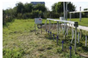
К одному пульту ПСИ могут быть подключены два блока БИР. Соединение кабельное.
