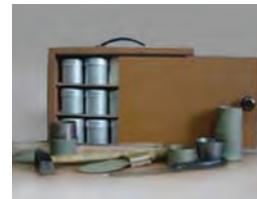
**Комплектность поставки:** Состоит из двух цилиндров буровых, воронки, бойка, ножа, молотка, лопатки, стаканов (30 шт) и упаковочного ящика.
