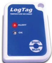
Термоиндикатор со светодиодной индикацией однократного использования. Два контролируемых порога температурного режима. Позволяет сохранять в памяти 3968 значений температуры в диапазоне от -25°C до +60°C, осуществлять пользовательскую настройку режима работы термоиндикатора и выгружать результаты мониторинга в ПК. Срок службы - до 6 месяцев.
