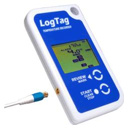
Термоиндикатор со встроенным ЖК-дисплеем и заменяемой батареей в комплекте с выносным датчиком, для многократного мониторинга температурного режима. Индикация сводного отчета на дисплее за 30 суток. Диапазон рабочей температуры от -40°C до +99°C. Позволяет осуществлять пользовательскую настройку режима работы термоиндикатора и выгружать результаты мониторинга в ПК. Срок службы, обусловленный ресурсом работы батареи - не менее 1 года.
