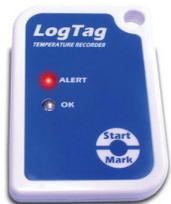
Термоиндикатор со светодиодной индикацией для многократного мониторинга температурного режима. Два контролируемых порога температурного режима. Позволяет сохранять в памяти до 16000 значений температуры в диапазоне от -40°C до +85°C, осуществлять пользовательскую настройку режима работы термоиндикатора и выгружать результаты мониторинга в ПК. Срок службы - не менее 2-х лет.
