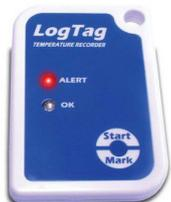
Термоиндикатор со светодиодной индикацией для многократного мониторинга температурного режима. Два контролируемых порога температурного режима. Позволяет сохранять в памяти до 8000 значений температуры в диапазоне от -40°C до +85°C, осуществлять пользовательскую настройку режима работы термоиндикатора и выгружать результаты мониторинга в ПК. Срок службы - не менее 2-х лет.
